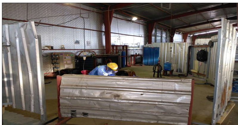
Hình 2.6: Quây chắn các khu vực hàn và cắt
